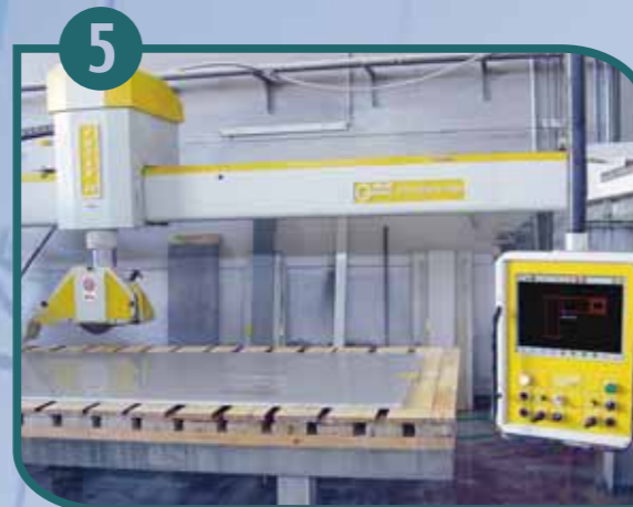
5 Le croquis électronique est téléchargé dans le programme de la machine à découper, quelle soit une scie, une scie hydraulique, un CNC.
