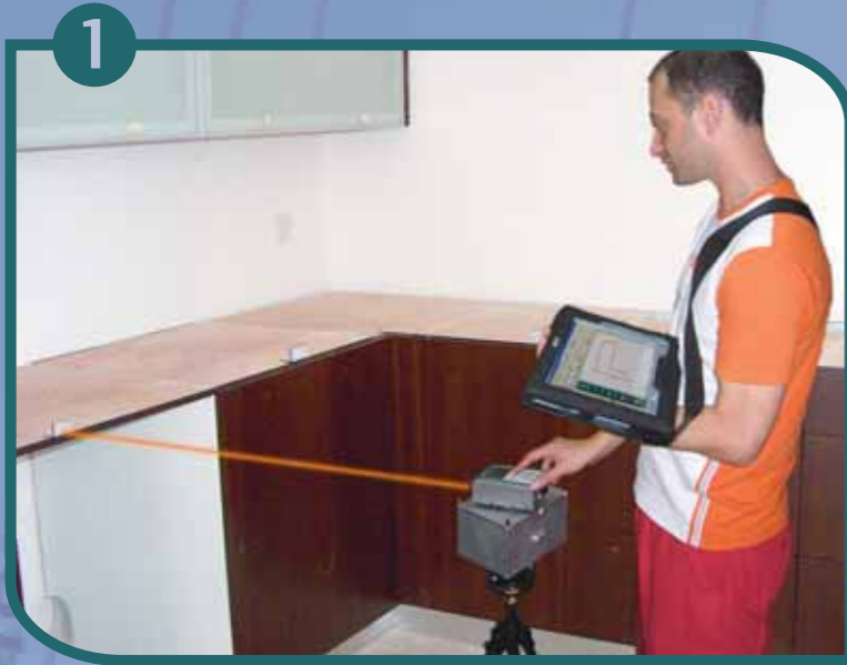
1 Le technicien métreur dessine et prend les mesures via un viseur intégré au système laser InnoDraw.
