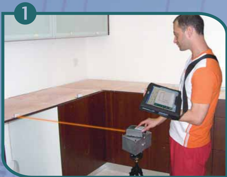
1 La persona adibita a prendere le misure usa il Sistema Laser INNODRAW con la facile procedura di puntare e cliccare.
